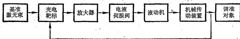
图2 激光自动准直系统方框图
