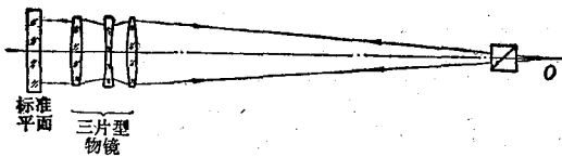
图 14 用平面自准直法检验三片型物镜
