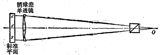
图 15 用平面自准直法检验消球差单透镜
