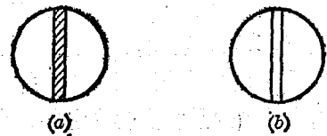
图 4 在正交偏光下观察孪晶的结果 (a) 斜切面 (b) 垂直切面
